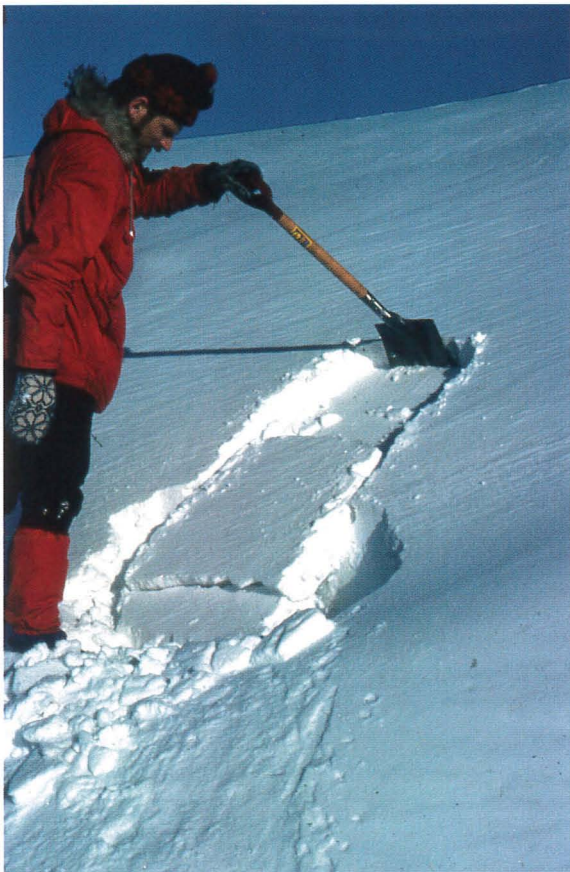
Foto 54. Spadeprøve. Snøblokken glir ut langs et svakt sjikt.
