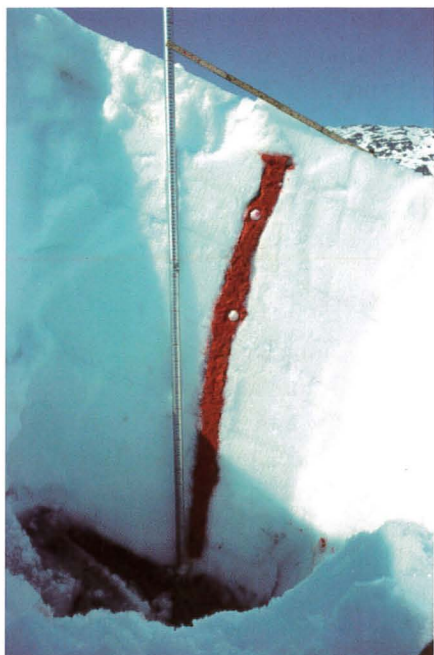
Foto 36. Sigebevegelse i snøen. Den røde sagflisen viser hvordan snøen har seget
